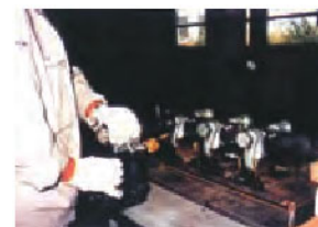
連結部の繰り返しせん断試験状況
